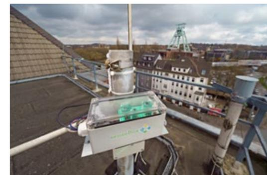
Wie ist das Klima an der THGA? Das kann nun jeder bequem mobil abfragen: Die neu installierte „Sensebox“ auf dem Dach der Hochschule liefert minutengenau Wetterdaten wie Temperatur, Luftfeuchtigkeit, Luftdruck, Beleuchtungsstärke oder den UV-Index. Auch die Feinstaubbelastung hoch über der Herner Straße oder die Lautstärke werden von der Messtechnik erfasst – dazu gehört auch das Hupkonzert der Italiener nach dem EM-Sieg 2021 mit mehr als 100 Dezibel oder eine durchfahrende Feuerwehrkolonne.
